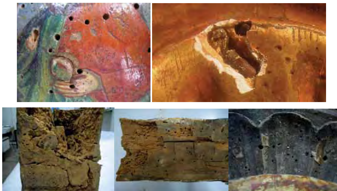
Fig.3 Deteriorări provocate de anobiide asupra iconostasului bisericii de cimitir „Sf. Ioan”, Agapia Impairing caused by anobiides to the iconostasis of the „Sf. Ioan” Agapia cemetery church,
